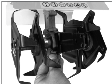
Рис. 5 Установка кронштейна сошника
