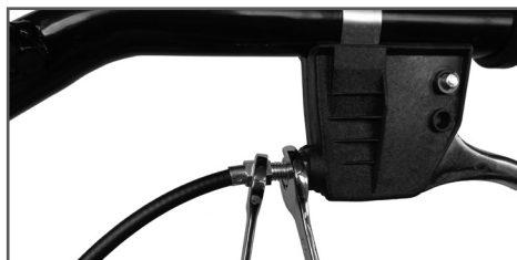
Рис. 10 Фиксация троса газа
