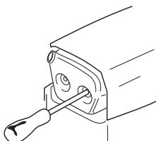
В некоторых глушителях предусмотрен специальный искрогаситель. Если ваша машина оборудована таким глушителем, сетку фильтра следует чистить раз в неделю. Наилучшие результаты дают стальной щеткой. Забитая решетка приводит к работе с горячим двигателем, что дает серьезные повреждения двигателя.
