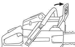
**Зажигание:** Установите переключатель зажигания в левое положение.
