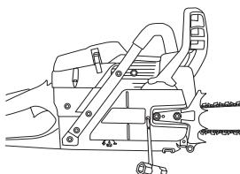
Цепь считается натянутой правильно, если она свободно проворачивается рукой. После этого, удерживая носок пильного полотна в верхнем положении, затяните гайки крепления пильного полотна универсальным ключом.
