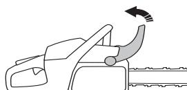
Будьте внимательны при работе и следите, чтобы зона отдачи пильного полотна не касалась никаких объектов.
