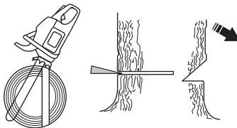
Закончить основной пропил нужно параллельно линии направляющего пропила так, чтобы расстояние между ними составляло около 1/10 диаметра ствола. Нераспиленный участок ствола называется полоса разлома (недопил).
