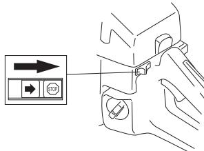
двигатель останавливается, когда контакт остановки будет передвинут в положение остановки.
