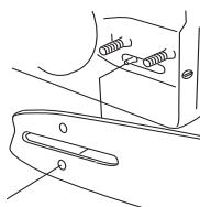
Для этого поверните винт механизма регулировки цепи по часовой стрелке. Цепь следует натягивать до тех пор, пока она не будет плотно прилегать к нижней стороне пильного полотна. См. указания в разделе Натяжение цепи пилы.
