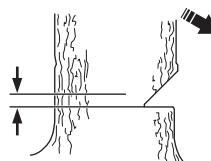
Вставьте зубчатый упор (если установлен), сзади надреза. Работайте на полном газу и вводите пильное полотно в ствол дерева постепенно, плавным движением. Следите за тем, чтобы дерево не начало перемещаться в направлении, противоположном предполагаемому направлению падения. Как
