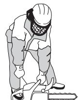
После того, как двигатель сделает первую вспышку, верните сразу рычаг воздушной заслонки в первоначальное положение, открывая воздушную заслонку, и повторите запуск. Когда двигатель запустится, дайте полный газ и отпустите рычаг дроссельной заслонки и блокировку пускового положения дроссельной заслонки отключится.
