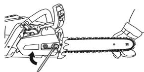
При установки новой цепи следует часто проверять ее натяжение, пока цепь не проработается. Регулярно проверяйте натяжение цепи. Правильно натянутая цепь обеспечивает высокое качество пиления и дольше служит.
