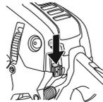
Остановка двигателя осуществляется нажатием на выключатель запуска/остановки.
