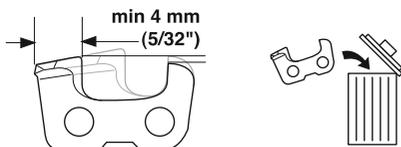
Общие сведения относительно снижения ограничителя глубины врезания.
