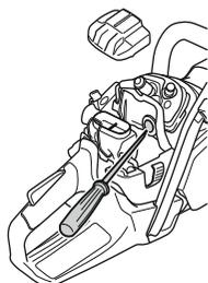
Для температуры ниже  $-5^{\circ}\text{C}$  и/или в условиях снегопада предусмотрена специальная крышка, укрепленная на корпусе стартера.
