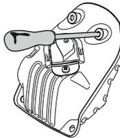
В некоторых глушителях предусмотрен специальный искрогаситель. Если ваша машина оборудована таким глушителем, сетку фильтра следует чистить раз в неделю. Наилучшие пользователи стальной щеткой. Забитая решетка приводит к работе с горячим двигателем, что дает серьезные повреждения двигателя.
