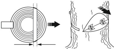
Возможность влияния на направление падения будет полностью утрачена, если полоса разлома слишком узкая или пропилована направляющий и основной пропиловы плохо размещены.
