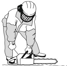
Твердо возьмите моторную пилу, обхватив ручки всей ладонью.
