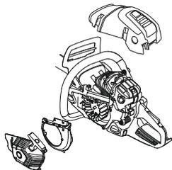
Производите очистку системы охлаждения щеткой раз в неделю или чаще, если этого требуют условия работы. Загрязненная или засоренная система охлаждения может привести к перегреву машины и вызвать повреждение поршня и цилиндра.
