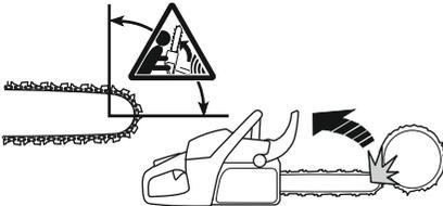
Резка нижней кромкой полотна, т.е. от поверхности объекта к нижнему краю известна как пиление с нажимом. В этом случае моторная пила сама наезжает на дерево и передний край моторной пилы соответствует естественному положению при резке. Пиление с нажимом обеспечивает
