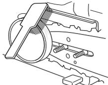
Регулярно проверяйте, чтобы лента тормоза была по крайней мере толщиной минимал 0.6 мм в самом изношенном месте.
