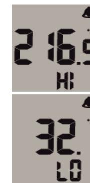
W celu ustawienia pożądanych wartości temperatur należy wcisnąć przyciski nad strzałkami. Począć 5 sekund na zapisanie ustawienia, a następnie opuścić menu.
