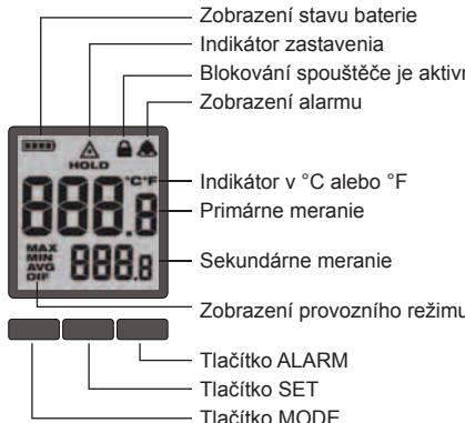
Pro zvolení požadované teplotní stupnice stiskněte spouštěč a třikrát stiskněte tlačítko SET. Pomocí tlačitek zvolte přes šipky °C a °F. Počkejte 5 sekund, až bude uložené nastavení a opusťte menu.
