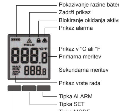
Za biranje poželjne skale temperature aktivirati okidač i tipku SET tri puta pritisnuti. S tipkama iznad strelica birati između
