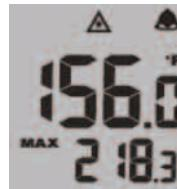
2. Ja ieslēgšanas pogu turpina turēt nospiestu, parādās simbols ▲ un tiek uzrādīta virsmas temperatūra (primārais mērījums) un maksimāla temperatūra (sekundārais mērījums).
