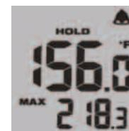
3. Izpustite sprožilec. Do izklopa prikaza bo po 7 sekundah prikazano HOLD.
