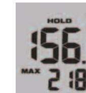
2. Если продолжать удерживать спусковой крючок, появится символ и отобразится температура поверхности (первичное измерение) и максимальная температура (вторичное измерение).
