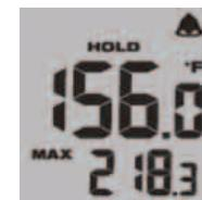
3. Den Auslöser loslassen. Bis zum Ausschalten der Anzeige nach etwa 7 Sekunden wird HOLD angezeigt.
